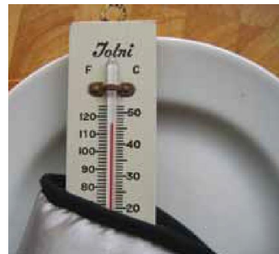
Kompres EyeBag o temperaturze 46,5°C bezpośrednio po wyjęciu z kuchenki mikrofalowej po 40 sekundach ogrzewania przy ustawieniu „dużej” mocy na kuchenke o mocy 850 W.
